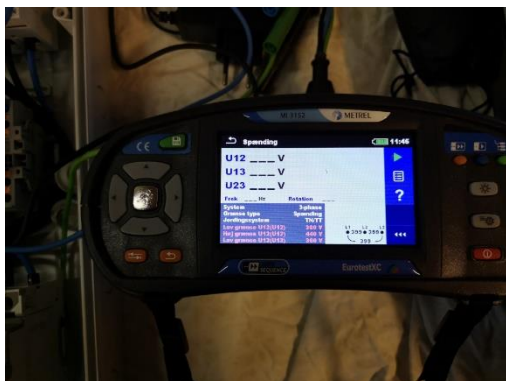
Indtast værdierne i det blå felt: Sytem sættes til 3-phase, grænsetype til spænding, jordingssystem vælges, og grænseværdier sættes (Anvendes til spændingstest)
